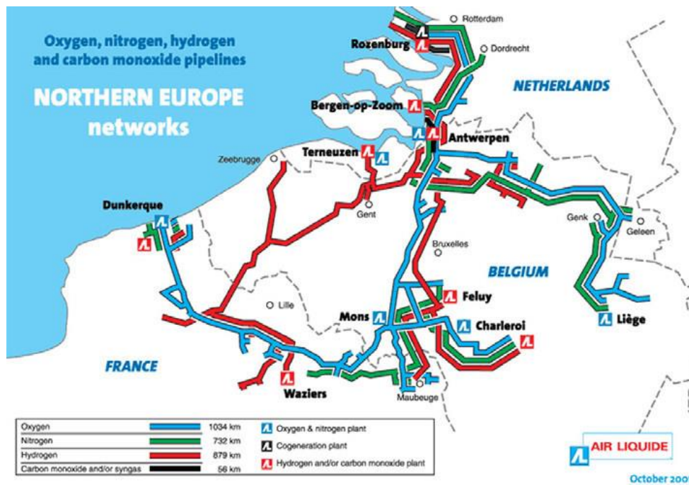
Figuur 3.5: Ondergronds waterstofleidingnet van Air Liquide
